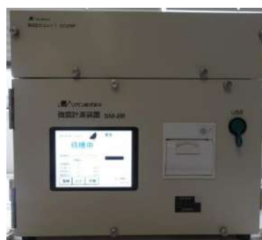
強震計測装置
